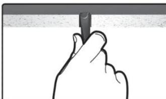
**2.** Insérer la cheville à ressort dans le trou en repliant les 2 pattes
