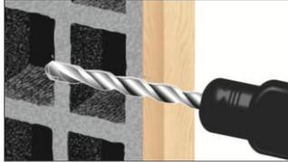
**1.** Percer au diamètre 8 ou 10mm
