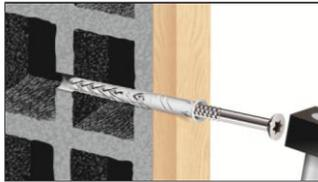
**2.** Insérer la cheville au travers de l'objet en frappant sur la vis à l'aide d'un marteau
