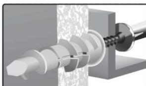
**3.** Visser jusqu'au contact de la vis avec l'objet
