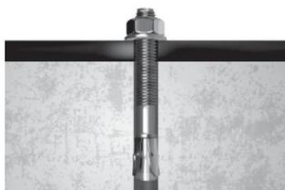
**4.** Serrer jusqu'au blocage à l'aide d'une clé adéquate
