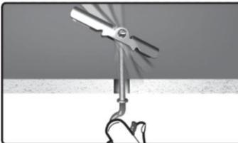
**3.** La bascule pivote et la fixation se met en place
