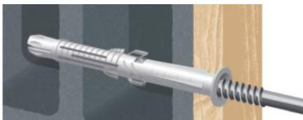
**3.** Serrer jusqu'au blocage à l'aide d'une visseuse ou d'une clé de serrage
